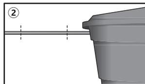
2 Seccione o cano de entrada da caixa d'água ou cavalete tendo como referência o filtro. O uso de luva de união facilita o conserto e manutenção caso ocorra vazamento após a instalação.
