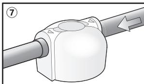
7 Cole a extremidade suspensa do cano no adaptador. O uso de uma luva de união para o caso de ocorrer vazamento após a instalação, facilita o conserto e a manutenção.
