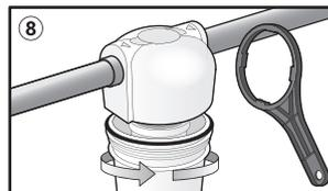
8 Observe se o anel o ring utilizado para a vedação do filtro está devidamente posicionado em seu alojamento. Rosqueie o copo na tampa do filtro. Utilize a chave para facilitar no fechamento.
