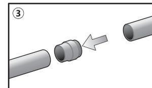
3 Usando cola para cano, cole um adaptador 25mm x 3/4 em uma extremidade do cano cortado.
