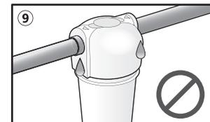
9 Abra o registro geral da água e, caso dê vazamento nas conexões, desrosquei-as e repita as instruções de instalação utilizando veda rosca.
