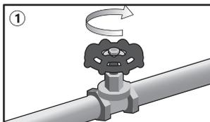
1 Feche o registro geral da água. Verifique o melhor local para instalar seu filtro, antes da caixa d'água ou junto ao cavalete (após o hidrômetro).
