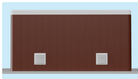
Figura 3 - grelhas de ventilação
