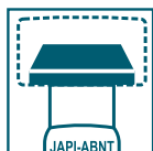
Anel cônico que proporciona melhor vedação
