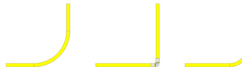
Figura 25 – Tubo Curvas / Figura 26 – Tubo Cotovelo / Figura 27 – Tubo Mola Curvadora.
