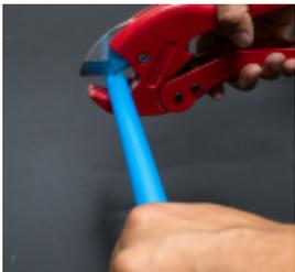
**1)** Cortar de forma perpendicular, utilizando a base da tesoura como apoio para o corte.
