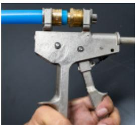
**3)** Introduzir a conexão na ponta alargada do tubo até a última nervura da conexão metálica.
