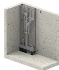
Montantes do drywall, chassi de chuveiro e primeira camada de impermeabilizante
