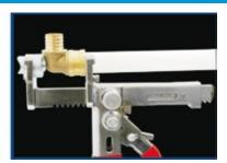
Acionar a prensa com pressões sucessivas até que o deslizante encoste na conexão
