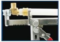
Introduzir a conexão na ponta alargada do tubo até a última nervura da conexão metálica.
