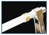
Alargar a extremidade do tubo com o alargador de tubos. O alargamento deverá ser realizado gradualmente, girando o alargador e expandindo progressivamente a ponta do tubo.
