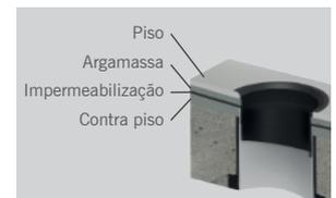
Para utilização no ponto do vaso sanitário, impermeabilize por dentro do tubo de PVC e posicione a bolsa de ligação (BS4) na parte superior.
