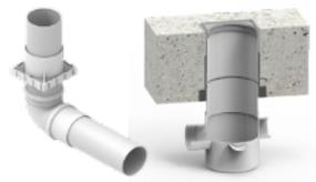
Faça a colagem da tubulação ou conexões de esgoto diretamente no corpo do passante utilizando cola de PVC padrão e após isso impermeabilize a passagem.
