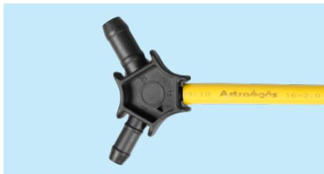
1. Cada uma das pontas do calibrador indica um diâmetro diferente. Insira o tubo na ponta correspondente ao seu tamanho e gire o calibrador de 3 a 4 vezes.
