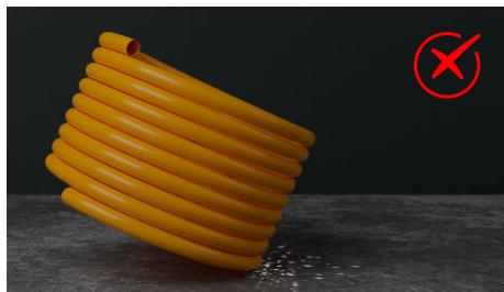
Durante transporte e armazenagem, os tubos devem ser posicionados em superfície plana e seca, não abrasiva, longe de objetos pontiagudos e a temperatura ambiente inferior a 60°C. Além disso, os tubos não podem ser arrastados pelo chão ou sofrer outros tipos de atrito.
