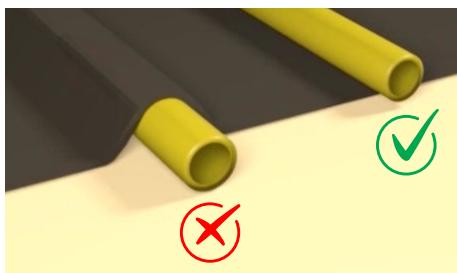
No cubra la tubería con mantas aislantes o impermeabilizantes para evitar el calentamiento.
