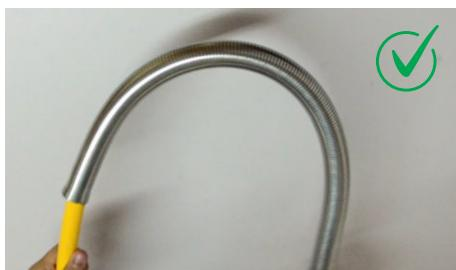
A mola de curvatura ajuda a moldar o tubo com precisão em altas angulações e sem dano.
