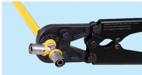
3. Posicione a ferramenta encostada na parte amarela da conexão e faça a crimpagem.
