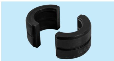
**1.** Escolha o inserto correto de prensagem (o inserto apropriado para prensagem tem que ter o diâmetro igual à medida externa do tubo a ser prensado).
