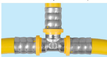
4. Despues de la crimpadura, abra los mangos de la herramienta. La conexión presentará 3 ranuras, como se ilustra en la imagen. Utilice la plantilla para verificar si la crimpadura está correcta, es decir, dentro de su tolerancia.
