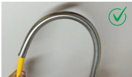
La herramienta de curvado ayuda a moldear la tubería con precisión en altas angulaciones y sin daños.
