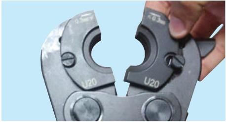
**1.** Seleccione el inserto correcto para prensado (el inserto apropiado para prensado debe tener el diámetro igual a la medida externa de la tubería a ser prensado).
