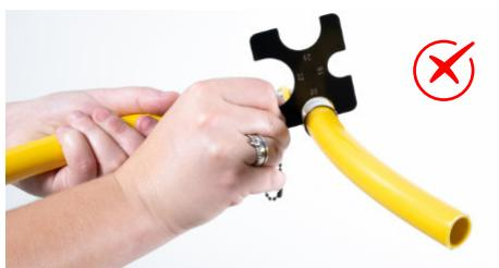
Si la plantilla no encaja, la crimpadura está fuera de la tolerancia de prensado. Entonces es necesario calibrar la herramienta según el manual.
