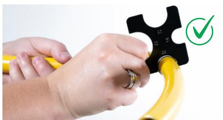
Encaje la tubería en la abertura de la plantilla correspondiente a su diámetro. Si el encaje se realiza correctamente, la crimpadura es correcta. Sin embargo, si no se puede hacer o queda suelta, la crimpadura es incorrecta.
