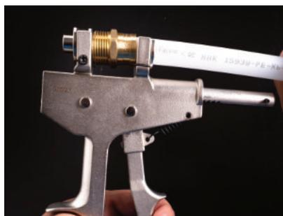
**4)** Acionar a prensa com pressões sucessivas até que o anel deslizante encoste na conexão.
