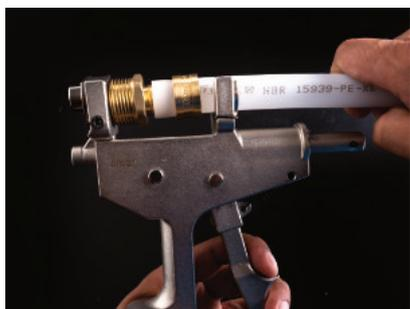
**3)** Introduzir a conexão na ponta alargada do tubo até a última nervura da conexão metálica.
