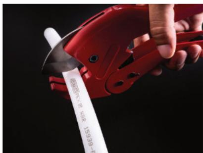
**1)** Cortar de forma perpendicular, utilizando a base da tesoura como apoio para o corte.
