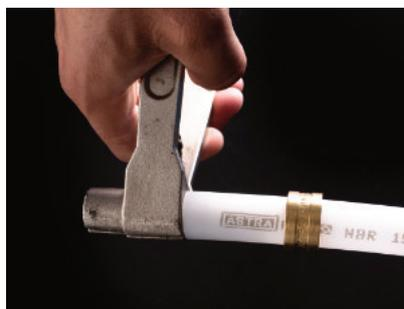
**2)** Inserir o anel e alargar a extremidade do tubo com o alargador de tubos. O alargamento deverá ser realizado gradualmente, girando o alargador e expandindo progressivamente a ponta do tubo.
